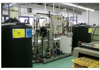
Quando le concentrazioni di inquinanti e la salinità dei lavaggi sono molto basse è possibile raggiungere con un solo stadio di osmosi inversa rapporti di concentrazione elevati, tanto che lo scarico concentrato può essere inviato direttamente, o previa ulteriore riduzione con evaporatore, allo smaltimento esterno.
