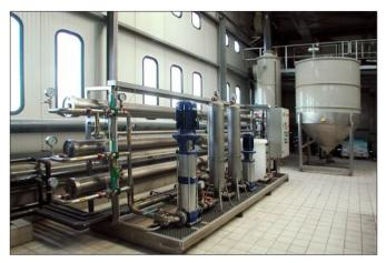
Quando esiste già un impianto chimico-fisico che "lavora" bene o non è possibile eseguire la separazione degli scarichi in funzione del loro carico inquinante, si può comunque risparmiare sino al 60-70% dell'acqua scaricata, applicando un impianto di osmosi inversa sulle acque depurate chimicamente.
