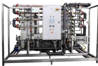
Ultrafiltrazione con membrane pluritubo
