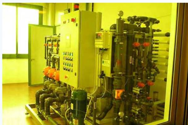
Impianto ultrafiltrazione sviluppo dry/film – 200 lt/h
