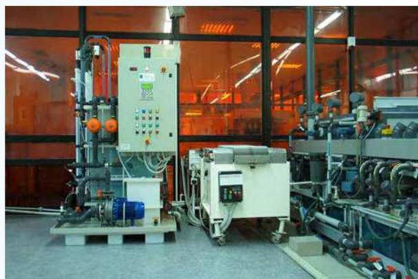
Impianto ultrafiltrazione sviluppo solder – 100 lt/h
