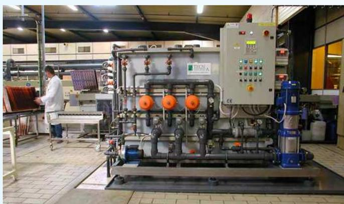
Impianto ultrafiltrazione sviluppo dry/film – 400 lt/h
