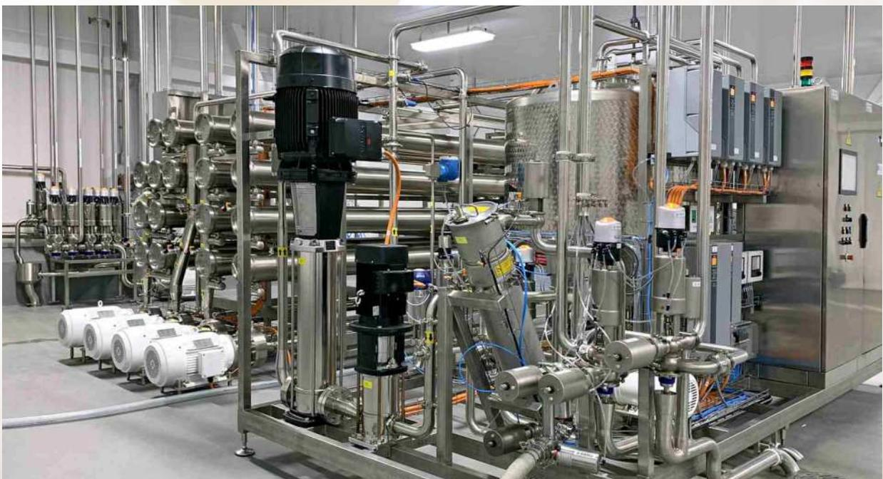
La **NANOFILTRATION**, de son côté, enlève l'eau, les sels monovalents (le chlorure de potassium et de sodium) et une partie des sels de calcium et de magnésium contenus dans le lactosérum pour ainsi concentrer le lactosérum et le déminéraliser partiellement.
